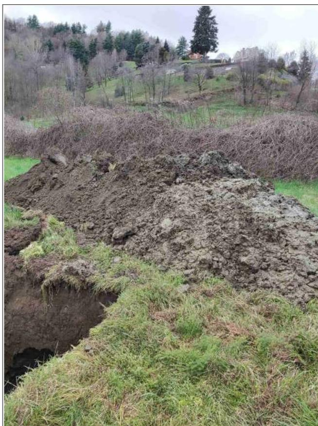
**Foto 3 e 4** – vista del pozzetto n°1 con la falda stabilizzata e vista del materiale di scavo di cui quello in primo piano è saturo d'acqua (sabbie con ghiaie e ciottoli di geometria tabulare (gnieiss)).
