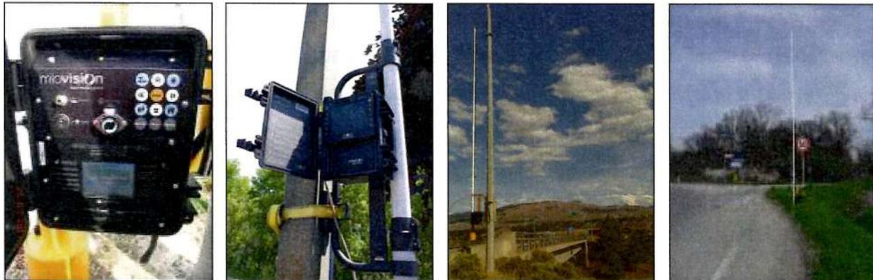
Per quanto concerne invece le telecamere ad infrarossi, tali apparecchiature consentono un rilievo ottimale anche in condizioni di illuminazione non adeguata. Vengono montate all'interno di box a tenuta stagna, e si compongono di una batteria ed un videoregistratore tecnologicamente avanzato, di dimensioni estremamente ridotte, il quale salva i dati filmati su schede microSD.
