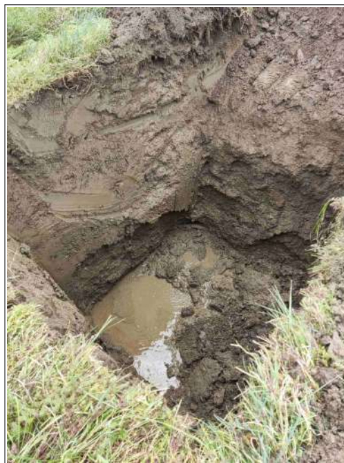
Foto 1 e 2 – vista del pozzetto n°1 con il limo sabbioso a tetto ed alla base le sabbie con depositi detritici. All'interfaccia si sviluppa una falda freatica che dopo poco tempo riempirà il fondo scavo.
