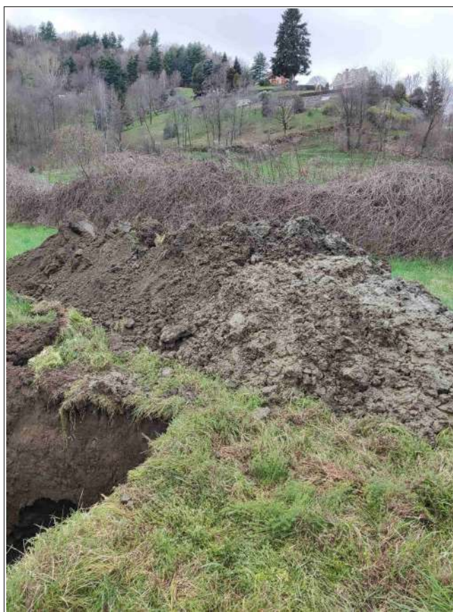
Foto 3 e 4 – vista del pozzetto n°1 con la falda stabilizzata e vista del materiale di scavo di cui quello in primo piano è satura d'acqua (sabbie con ghiaie e ciottoli di geometria tabulare (gnieiss)).
