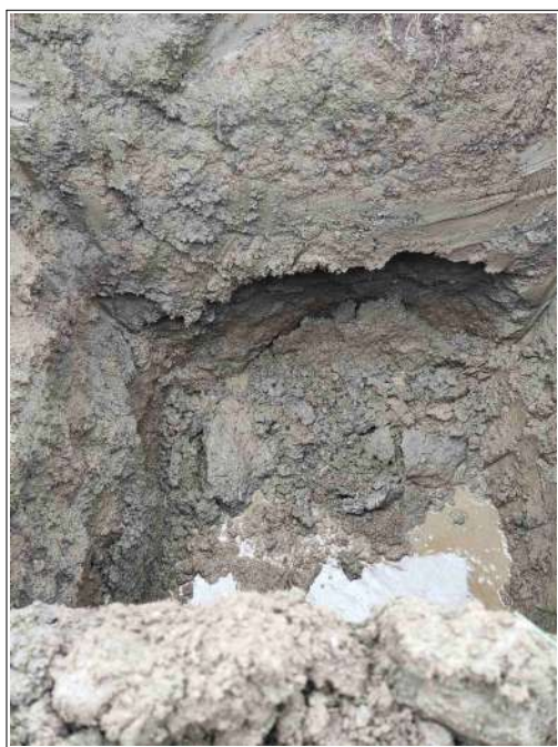
Foto 1 e 2 – vista del pozzetto n°1 con il limo sabbioso a tetto ed alla base le sabbie con depositi detritici. All'interfaccia si sviluppa una falda freatica che dopo poco tempo riempirà il fondo scavo.
