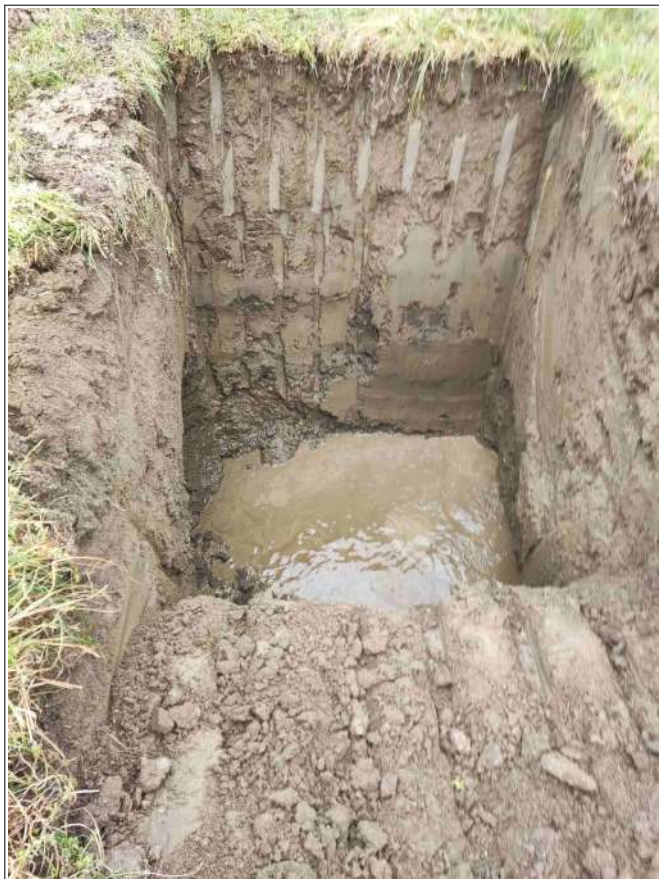
Foto 3 e 4 – vista del pozzetto n°1 con la falda stabilizzata e vista del materiale di scavo di cui quello in primo piano è satura d'acqua (sabbie con ghiaie e ciottoli di geometria tabulare (gnieiss)).
